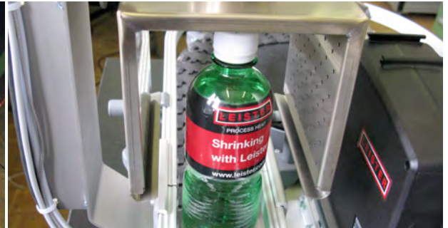
在热缩工艺中提供热风的HOTWIND SYSTEM
