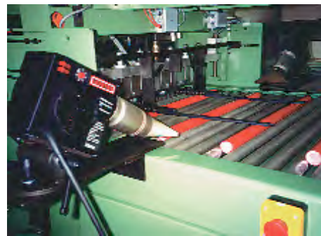
对装饰用的包装薄膜进行边缘热收缩。
