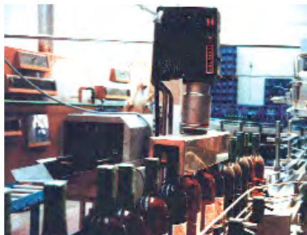
莱丹热风机和勺型反射风嘴用于红酒瓶瓶盖的热缩封装。
